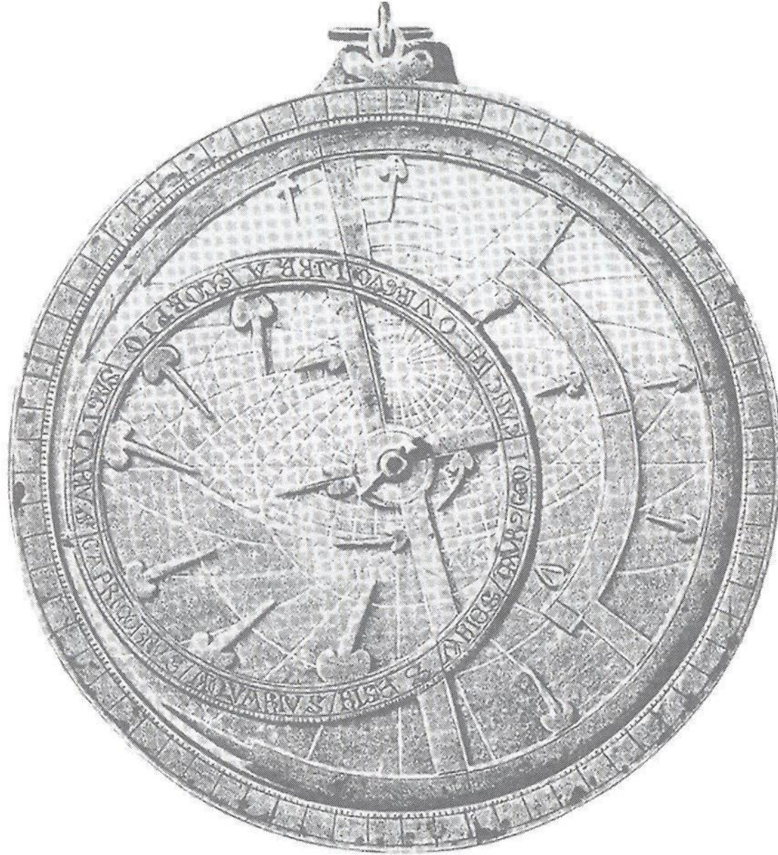
Abb. 3 Das älteste lateinische Astrolab (Katalonien, X. Jahrhundert; aufbewahrt in Paris, Institut du Monde Arabe, inv. no. AI 36-31). Auffallendster Teil des Instruments ist eine drehbare durchbrochene Metallscheibe, die «Spinne». Die tägliche Drehung des Fixsternhimmels wird imitiert, indem man die exzentrisch montierte Spinne im umfassenden Kreis dreht. Die Rückseite ist ein Visierinstrument.
